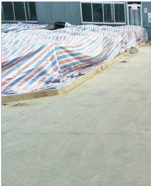
厂区物料覆盖及围堰
