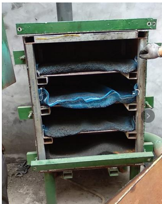
活性炭设备内部照片
