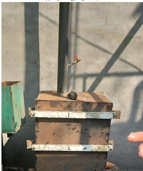
真空脱气活性炭吸附装置
